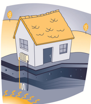
10. ábra: Talajszondás hőszivattyús fűtés egyszerűsített rajza
