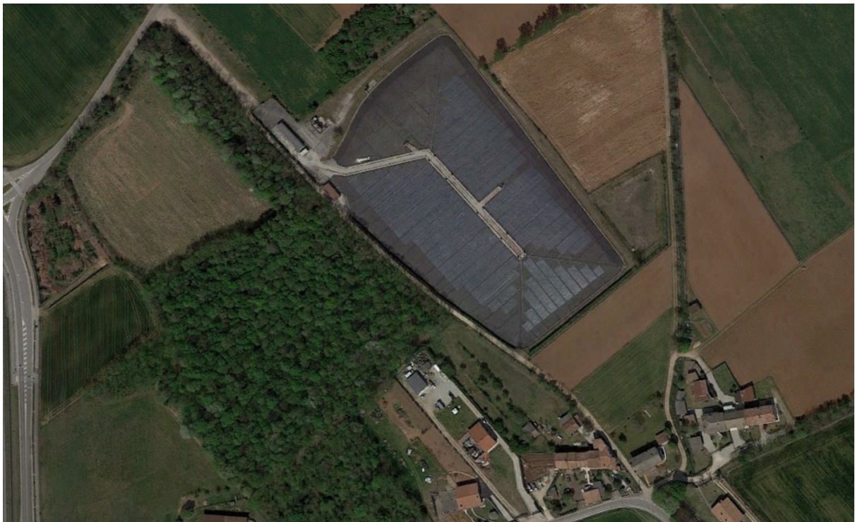
18. ábra: Nem tömörített hulladéklerakón, geomembrán felületen kialakított, 998 kW-os réz-indium-gallium-diszelenid vékonyfilmes napelemes rendszer Treviso településtől észak-nyugatra. 30 (Google Earth Pro felvétel)
