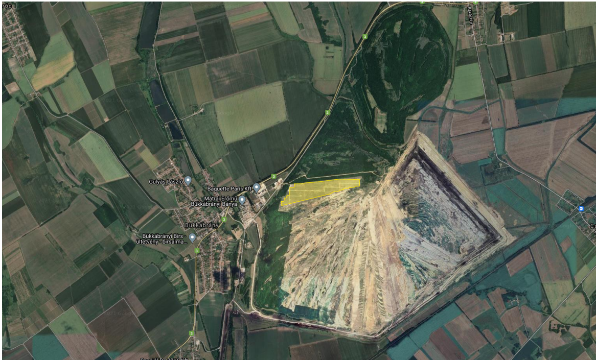
19. ábra: Élénksárga színnel kiemelve látható egy 27 hektáros, bányaművelés után rekultivált területen megvalósított 20 MW-os naperőmű Bükkábrányban. Tőle délre még rekultiválásra váró terület, tőle északra erdősítéssel rekultivált terület látszik (a feldolgozás Google Mymaps alkalmazással készült).
