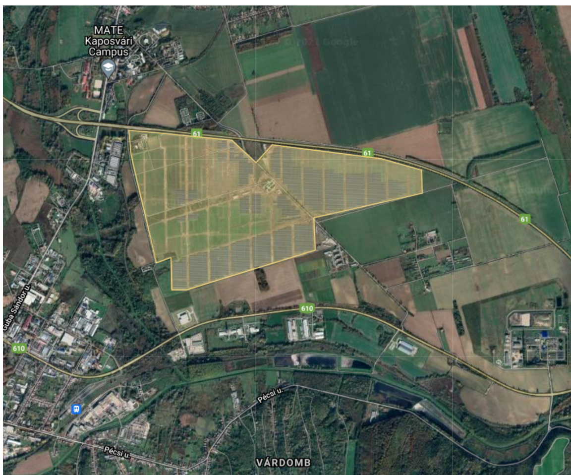
2. ábra: 100 MW teljesítményű, több mint 2 millió m 2 területigényű napelemes rendszer Kaposvár térségében (a mérés készült Google Mymaps alkalmazással, 2021. 12. 17.)
