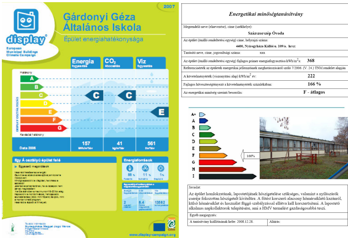
1. ábra: A Display címke és a Kormányrendelet szerinti energiatanúsítvány (forrás: Nagy Péter)
