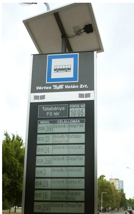
9. ábra Megállóhelyre telepített valós idejű információkat közlő kijelző Tatabányán
